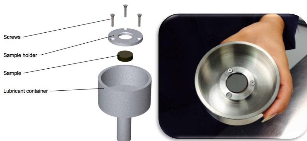
Figura 26. Colocación del disco en contenedor de lubricante [e].
