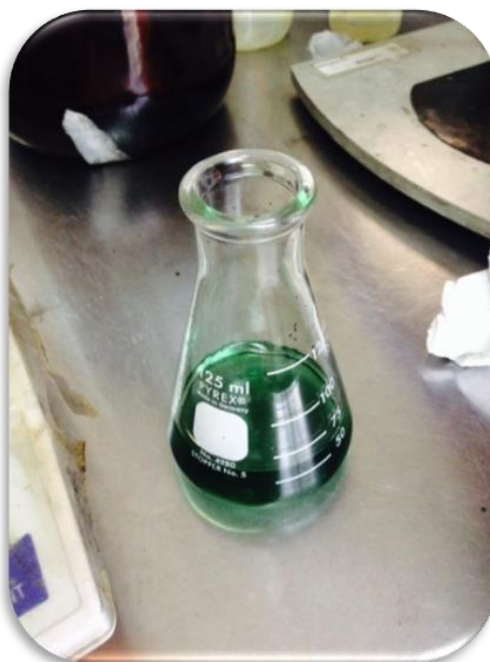
Figura 24. Obtención de la acidez total (cambio de color).
