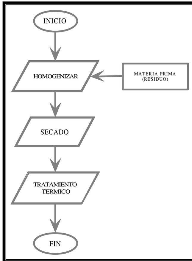
**Figura 13. Diagrama de flujo del proceso para elaborar el material vitrocerámico.**
