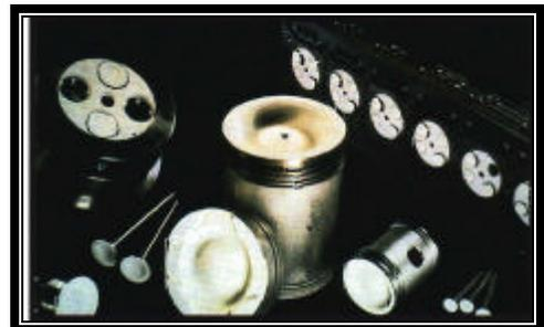
Materiales de *alúmina* ( $\text{Al}_2\text{O}_3$ ), que son usados para contener material fundido o para operar a alta temperatura donde se requiera buena resistencia. También se usa como sustrato aislante para soporte para circuitos integrados. Se han descubierto algunas propiedades para uso dental y médico, incluyendo restauración de dientes, relleno de huesos e implantes ortopédicos. Cuando la alúmina contiene impurezas de cromo se utiliza como láser.
