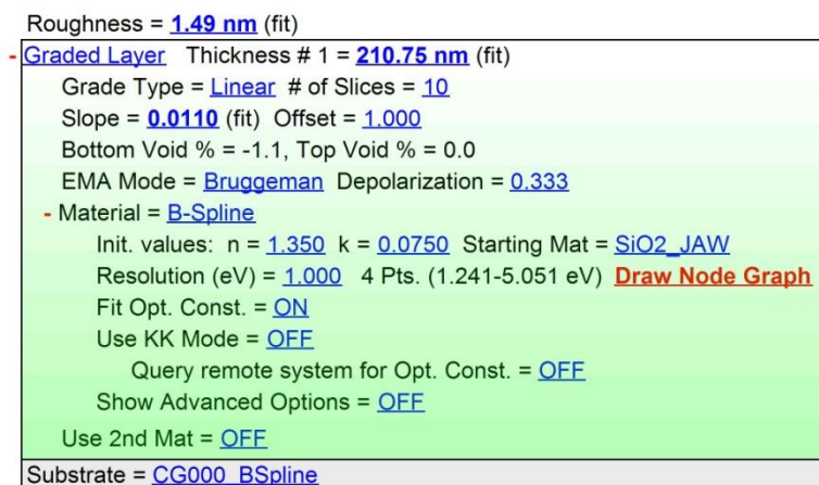
Figura 4.10 Modelo óptico empleado para ajustar constantes ópticas de película depositada a 25 mtorr a temperatura ambiente.
