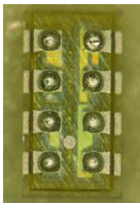
Fig. 1. Filtro 220 pitch usado en el vehiculo de pruebas.
