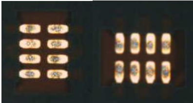
Fig. 2. Defectos en la impresión por insuficiencia, se usa una ampliación de las fotografías.
