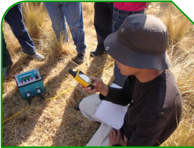
Figura 3.5. Colocación de los electrodos para el perfil de la tomografía eléctrica en los alrededores del vertedero de San Mateo Mexicaltzingo.
