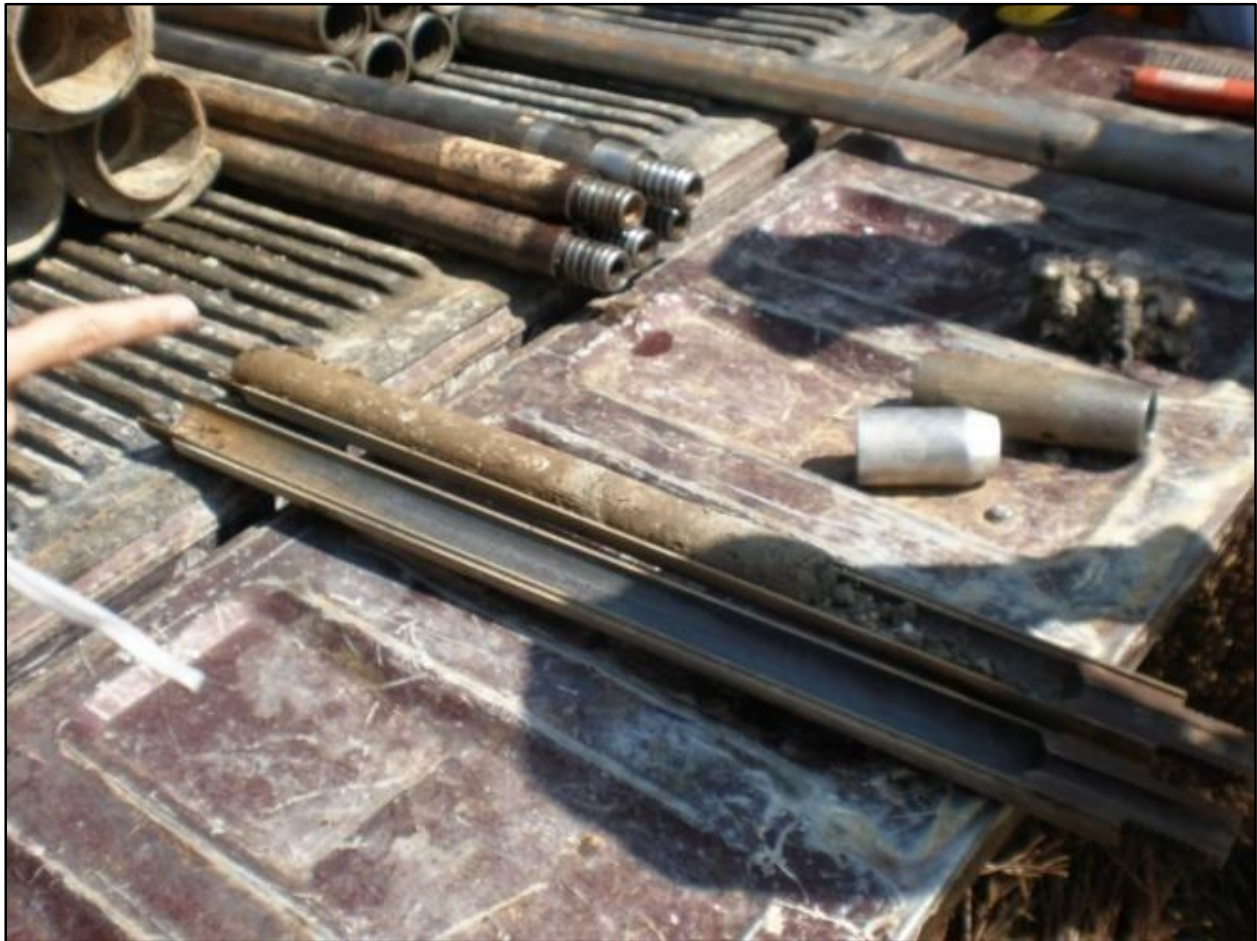
Figura 3.9. Muestreador de Denison para extracción de muestras de subsuelo
