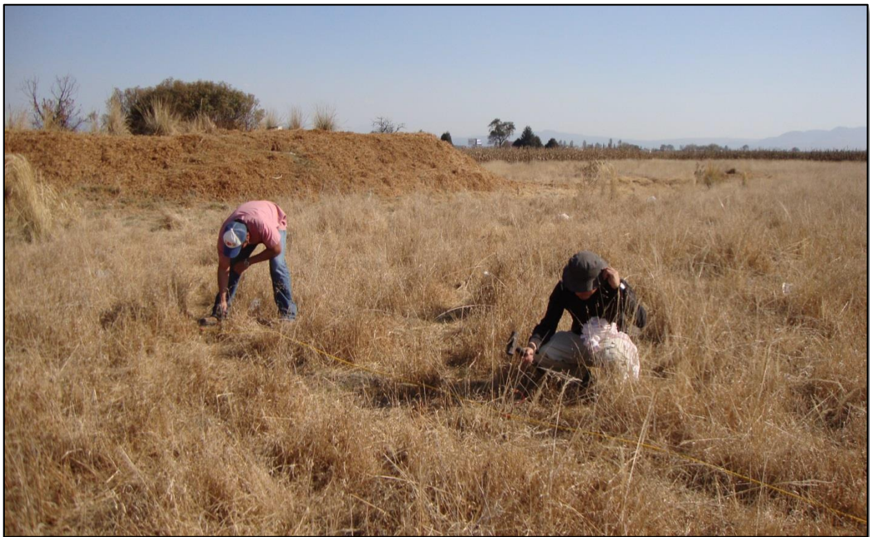
Figura 3.4. Colocación de los electrodos para el perfil de la tomografía eléctrica en los alrededores del vertedero de San Mateo Mexicaltzingo.
