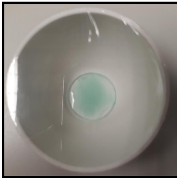
Fig.4-13. Película de gel preparada para recocido térmico.
