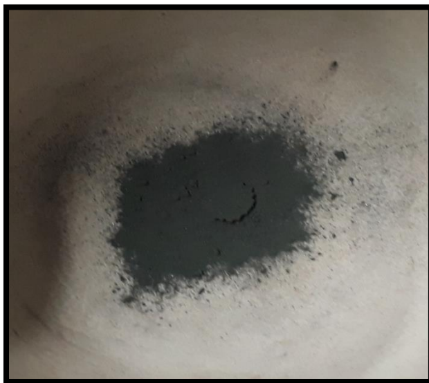
Fig.4-9. Polvo cerámico de NiO x obtenido después del proceso de calcinado a 800°C durante 1 hora.
