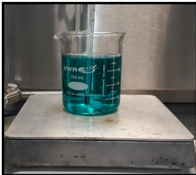
Fig.4-4. Solución precursora 0.1 M de \text{Ni}^{2+} + ácido cítrico + etilenglicol, ajustada a pH 8 con \text{NH}_4\text{OH} .
