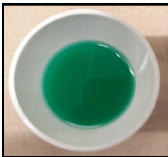
Fig. 4-6. Geles depositados en un crisol para ser sometidos al proceso de precalcinado.
