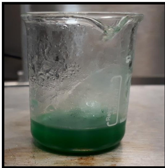
Fig.4-5. Geles precursores de NiOx, solución altamente viscosa.
