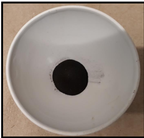
Fig. 4-8. Resina polimérica carbonacea macerada y lista para el proceso de calcinación.
