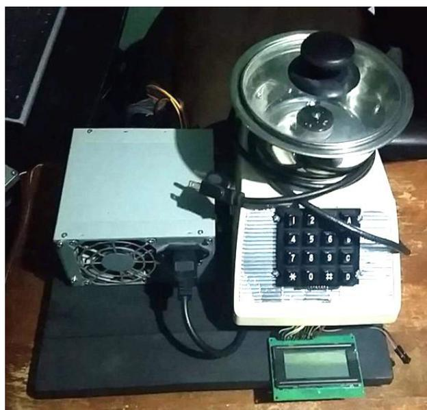
Figura 30. Equipo de equipo deposición por giro terminado
