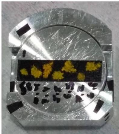
Figura 124. Porta muestras con CdS a analizar.
