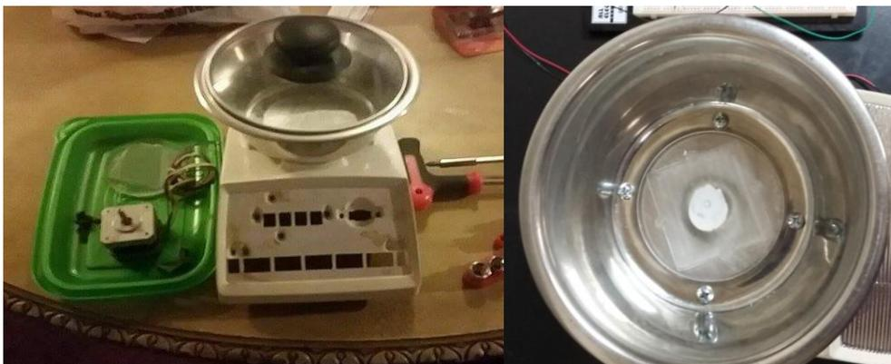
Figura 25. Proceso de construcción del equipo deposición por giro. A la izquierda ensamble de depósito en caja de licuadora, a la derecha proceso de perforación del depósito.
