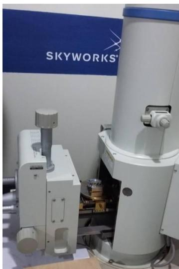
Figura 13. Equipo SEM JSM 6010LA.
