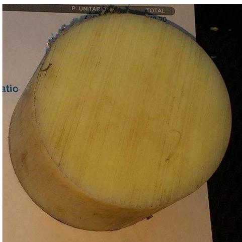
Figura 27. Nylon acero natural antes del maquinado
