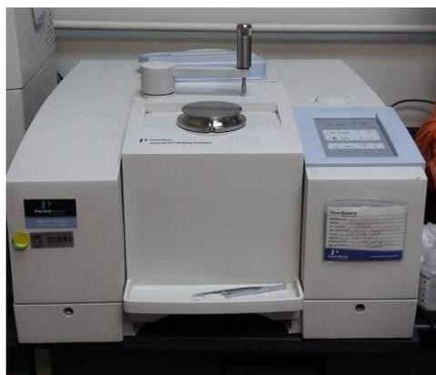
Figura 102. Espectrofotómetro FTIR Perkin Elmer Spectrum One.
