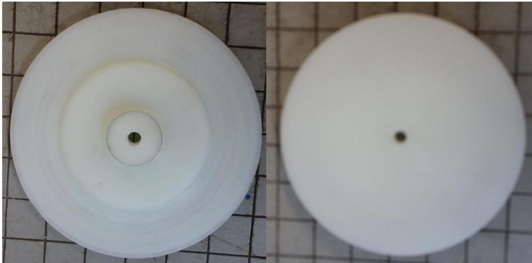
Figura 29. Nylon acero natural después del maquinado
