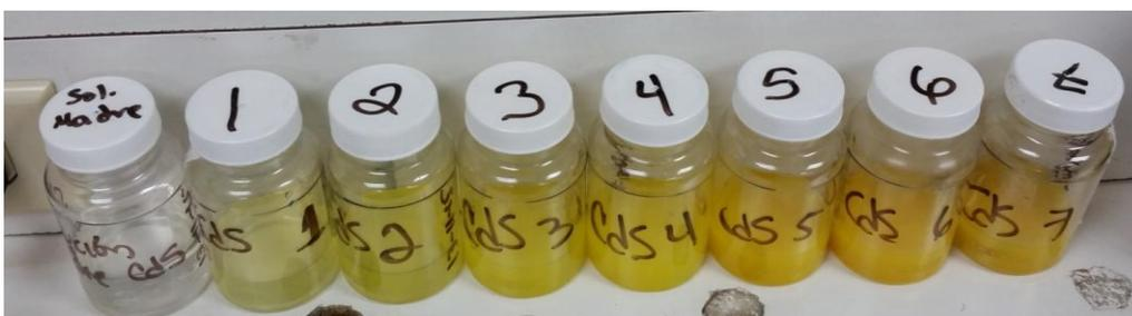
Figura 8. Tonalidades de amarillo en Solución coloidal madre y en muestras 1, 2, 3, 4, 5, 6 y 7 a los 40, 50, 60, 70, 80 y 90 minutos a 140 C respectivamente
