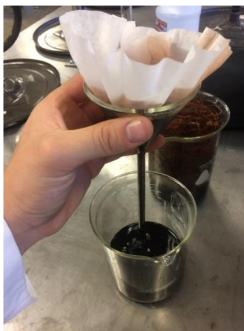
Figura 18. Filtrado de la solución NaOH y agua destilada.
