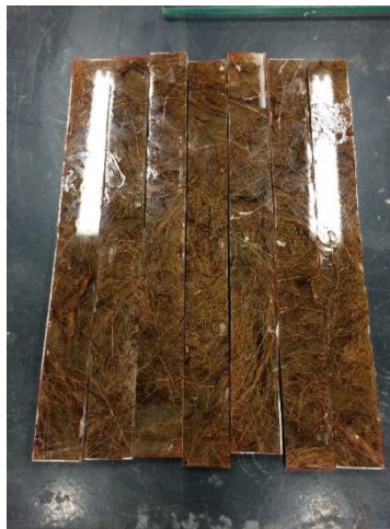
Figura 38. Probetas con dirección aleatoria obtenidas del laminado.
