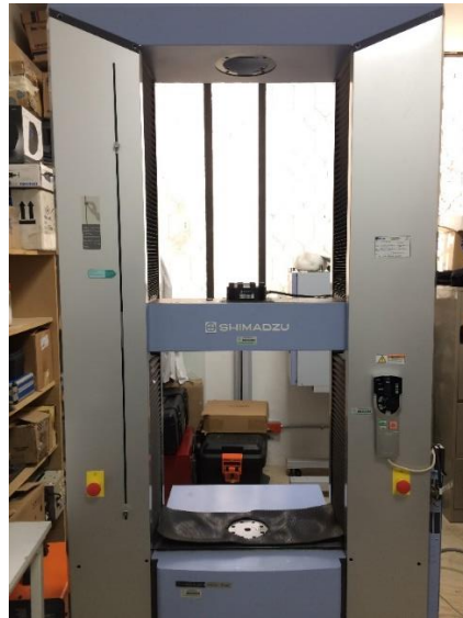
Figura 12. Máquina universal de ensayos Shimadzu AG-X Plus 100kN.
