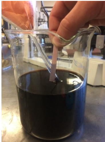
Figura 19. Prueba de acidez o alcalinidad utilizando una tira de papel PH.
