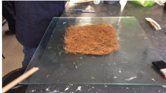
Figura 35. Mezcla de la fibra de coco con resina poliéster.
