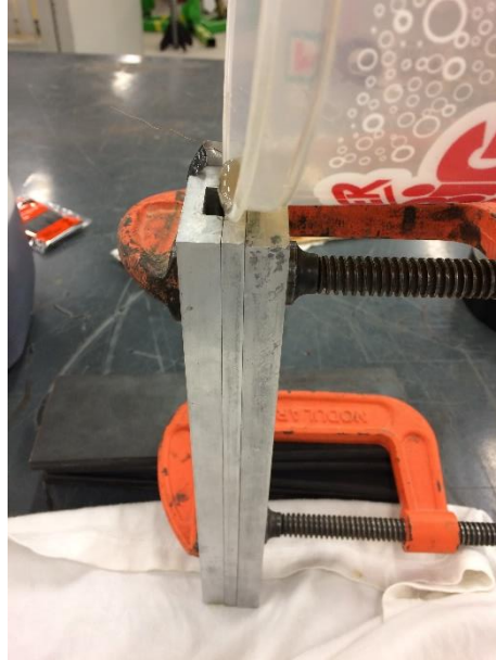
Figura 32. Resina poliéster es vertida dentro del molde para probeta tipo hueso.
