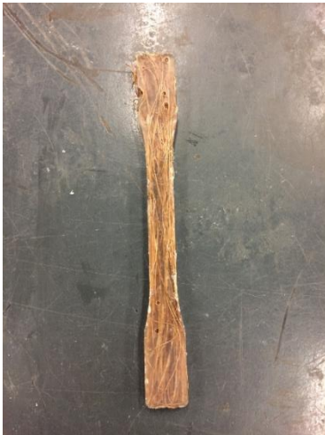
Figura 40. Uno de los cinco ejemplares obtenidos de probetas tipo hueso.
