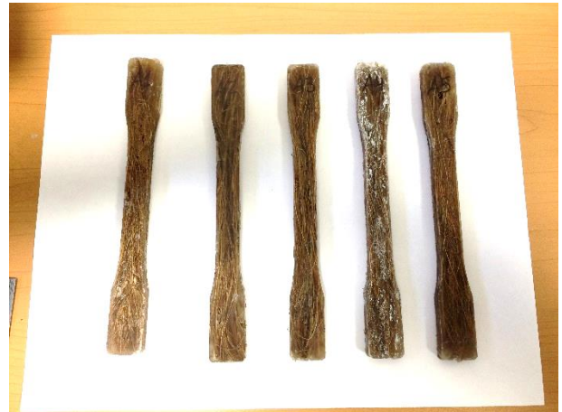
Figura 41. Probetas tipo hueso enumeradas (A1, A2, A3, A4, A5).
