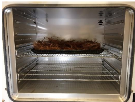
Figura 22. Horno térmico para el secado de la fibra de coco.
