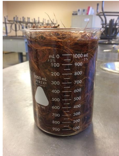
Figura 17. Vaso de precipitado de 1000ml con la mezcla y la fibra de coco.
