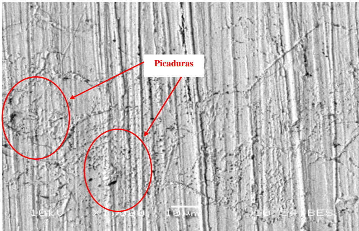
4.22 Micrografía de SEM (X500) sobre una superficie del estaño en Mexicali a los seis meses de exposición la empresa FURMEX.
