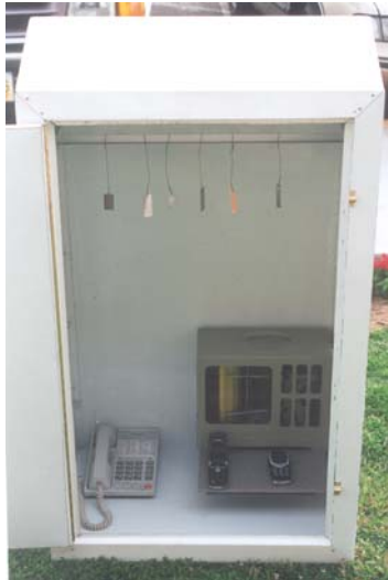
Figura 3.3. Detalle del montaje de muestras metálicas e instrumentación con higrómetro de la cabina de simulación de condiciones de interiores para ensayos de corrosión.
