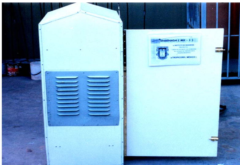
Figura 3.2. Cabina metálica para ensayos de corrosión bajo condiciones de interior de planta simuladas.
