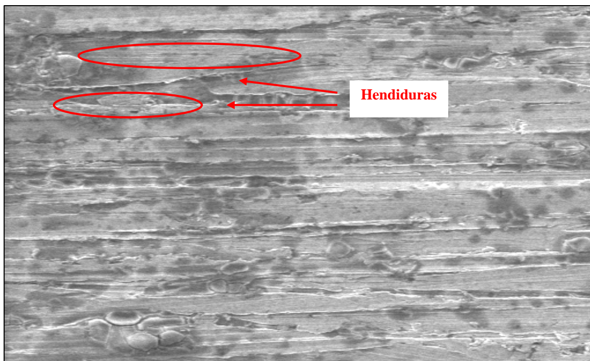
Figura 4.29. Micrografía de SEM (X500) sobre una superficie del níquel en Mexicali a los seis meses de exposición la empresa HONEYWELL.
