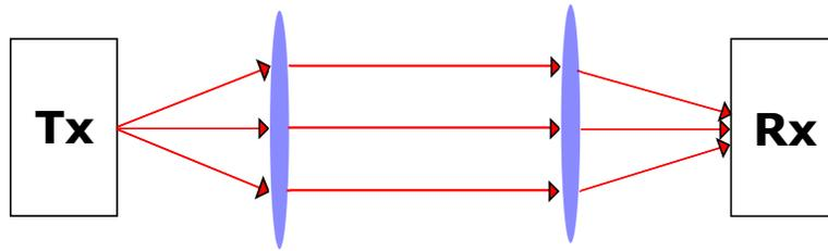
Figura 2.12: Transmisor y receptor IR
