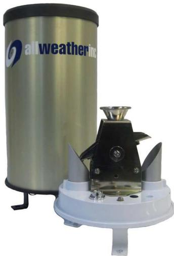
(a) Pluviómetro de cubeta basculante 2
