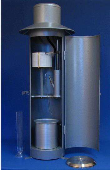
(a) Pluviómetro flotador
