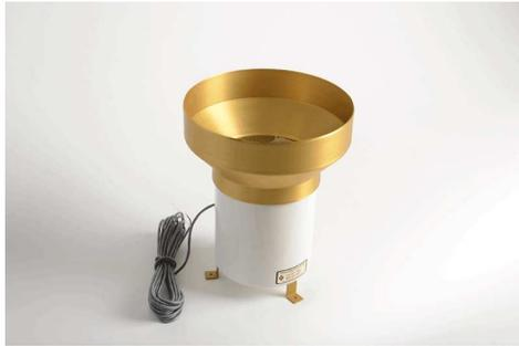
(a) Pluviómetro de cubeta basculante
