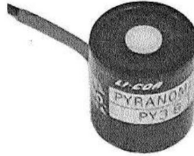
Figura 4.9: Medidor de radiación solar directa.
