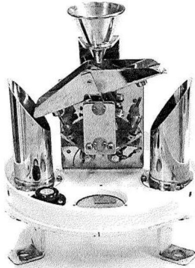
Figura 4.6: Pluviómetro de cazoletas basculantes.
