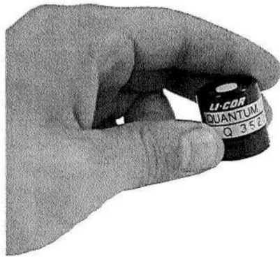
Figura 4.10: El sensor de radiación fotosintéticamente activa ( izquierda ) detecta longitudes de onda en el espectro electromagnético de 400 a 700 nm, que constituye el rango de radiación útil para las plantas ( derecha ).
