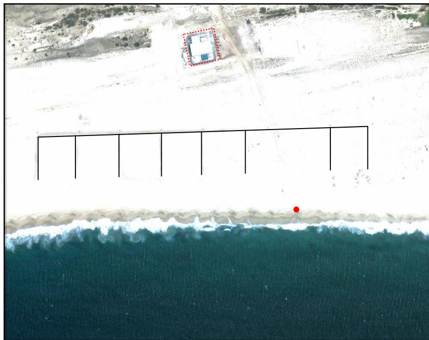
Figura 4. Vista aérea de los pozos playeros de la planta desalinizadora del municipio de Los Cabos. El punto rojo es la ubicación de la descarga de salmuera. Imagen tomada de Google Earth, 2011.
