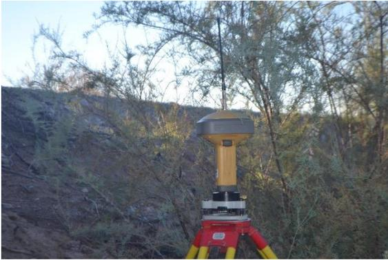
Figura 20. Equipo GPS GR-5 utilizado para el levantamiento topobatimétrico
