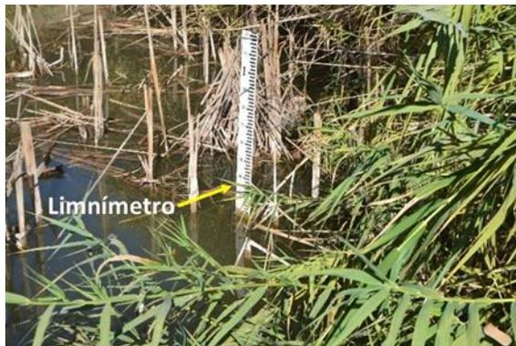
Figura 11. Limnómetro instalado en el sitio Ayala #1.
