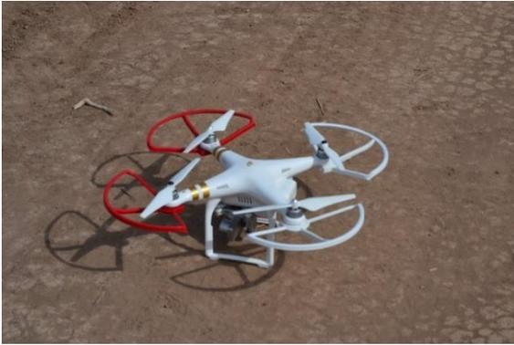
Figura 14. Dron utilizado para la adquisición de imágenes aéreas
