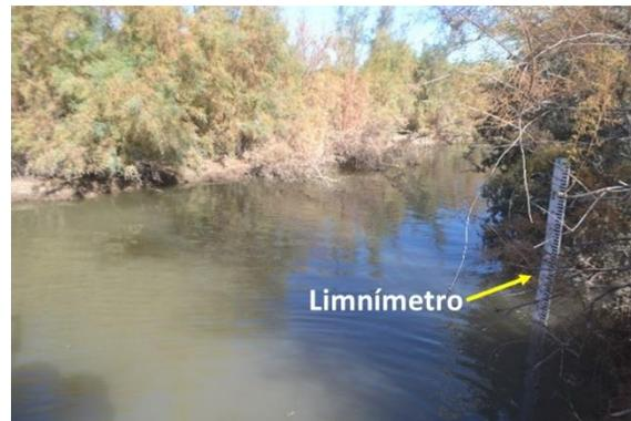
Figura 12. Limnómetro instalado en el sitio Ayala #2.
