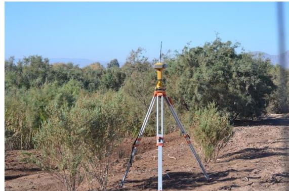
Figura 23. GPS GR-5 colocado en el punto de liga
