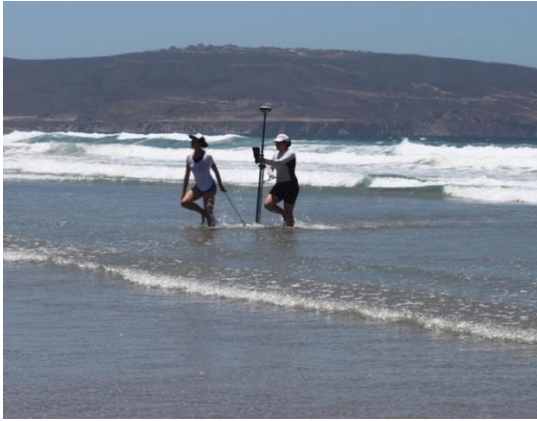
Figura 5.3. 2 Realización de topografía con antena GPS montada sobre el bastón con ruedas (izq) y Mediciones batimétricas con ecosonda y antena GPS acopladas a una moto acuática (der).
