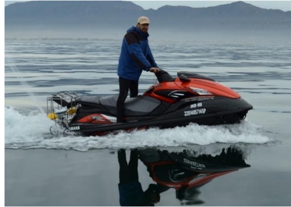
Figura 5.3. 2 Realización de topografía con antena GPS montada sobre el bastón con ruedas (izq) y Mediciones batimétricas con ecosonda y antena GPS acopladas a una moto acuática (der).
