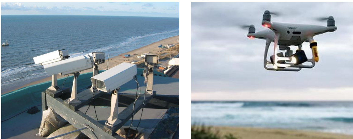
Figura 4.3. 1 Estación fija de video-monitoreo costero en Noordwijk (Holanda; panel izquierdo) y ejemplo del uso de un dron como estación de video-monitoreo móvil (panel derecho); ambos utilizados para el monitoreo de la morfodinámica de playas de forma remota.
