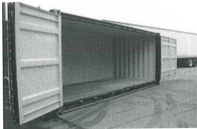
Figura 13. Contenedor Open Side.
