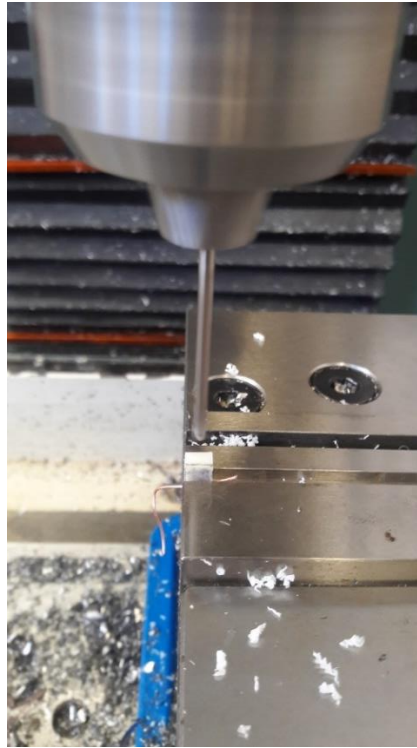
Imagen 101: Realizando el barreno a las paletas que fungirá para unir el cilindro con la paleta.
