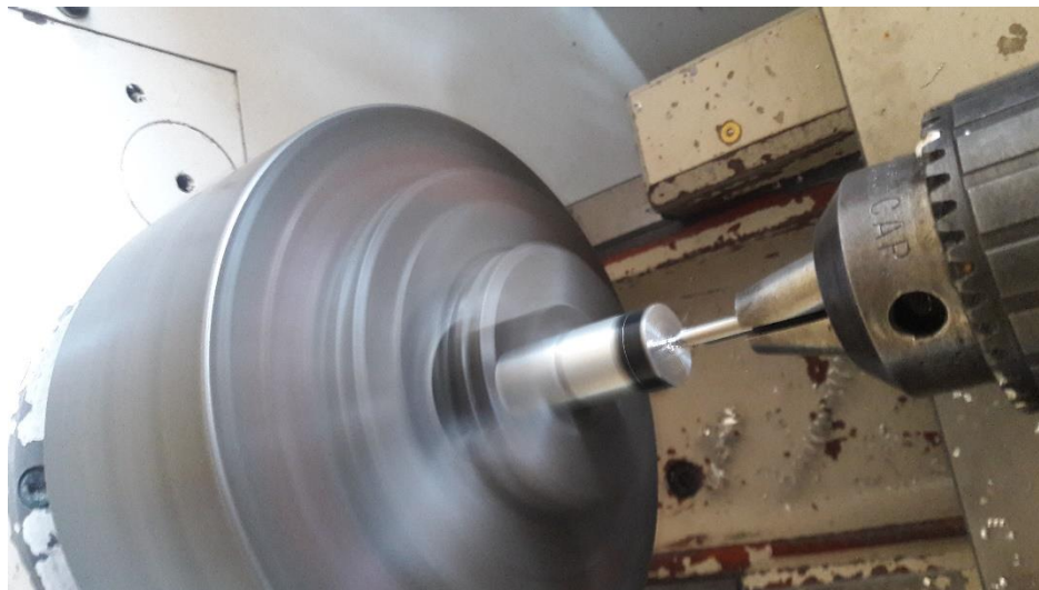
Imagen 114: Realizando el barrenado con la broca de centro.
