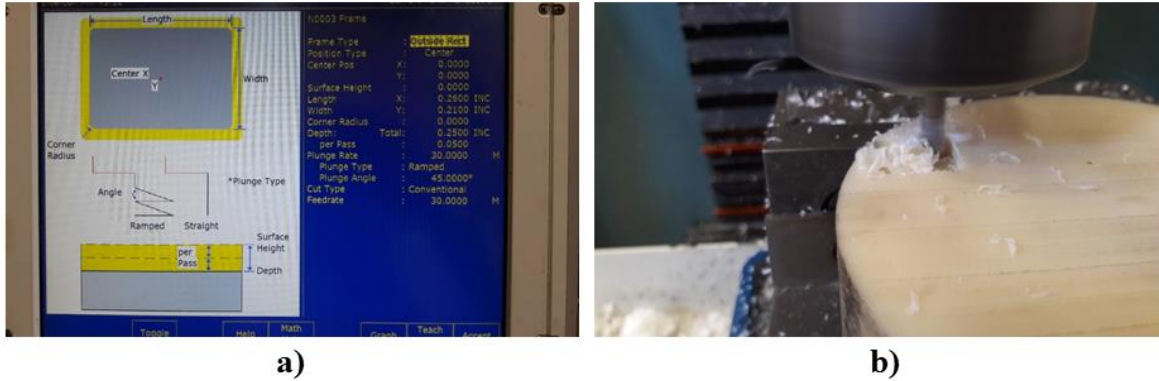
Imagen 97: a) Programando la CNC para obtener los cilindros y las paletas del mezclador, b) Empezando con los cortes en la pieza.
