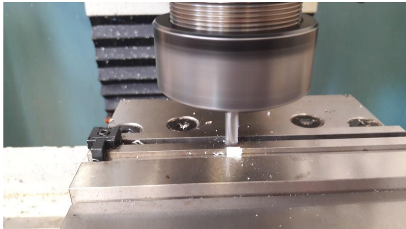
Imagen 100: Maquinando las paletas para obtener el ancho de las paletas calculado.
