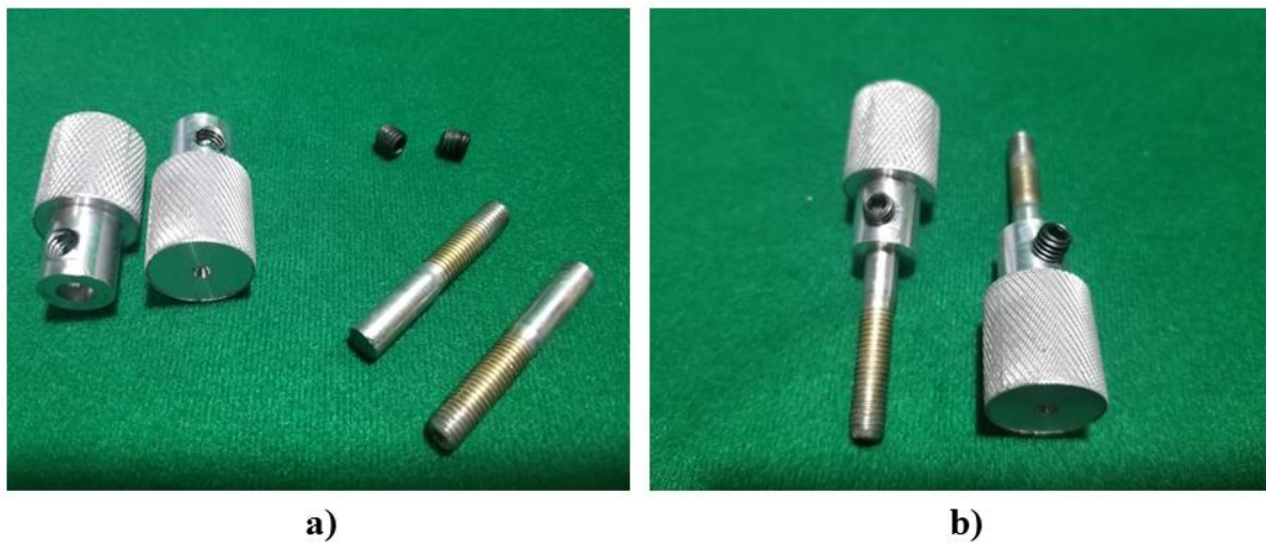
Imagen 128: a) Las 3 partes que conforman al tornillo, b) Ensamblado el tornillo que fungirá para mantener cerrado el mezclador.
