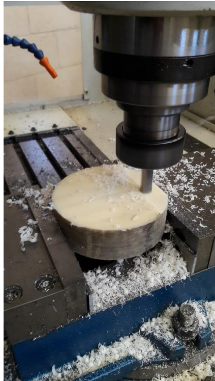
Imagen 96 : Realizando el careo superficial a la pieza cilíndrica.
