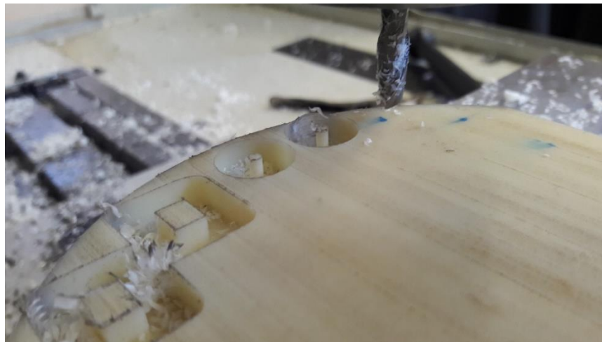
Imagen 98: Maquinando los cilindros pequeños y paletas del mezclador.
