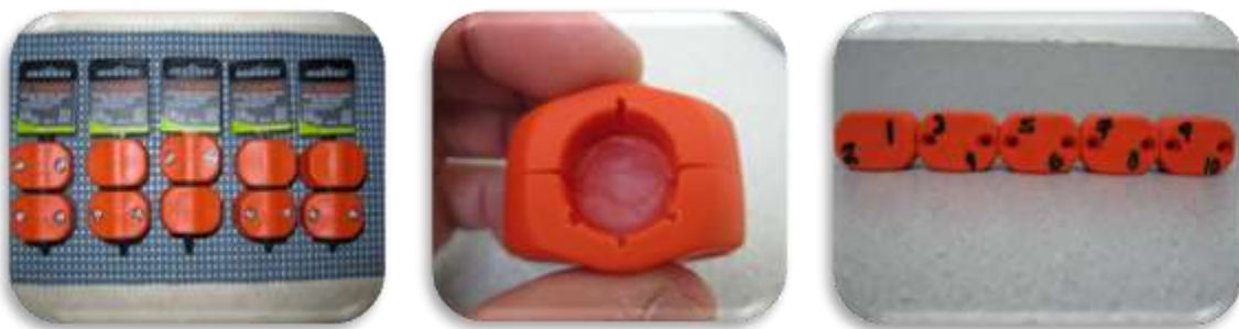
Fig 4. Se emplearon anillos plásticos para reparar mangueras de jardín (Truper), como moldes para los bloques deacrílicos donde se colocaron las muestras radiculares. Se observan las muescas realizadas para evitar el movimiento del bloque deacrílico. Se enumeran para una mejor organización de las muestras.
