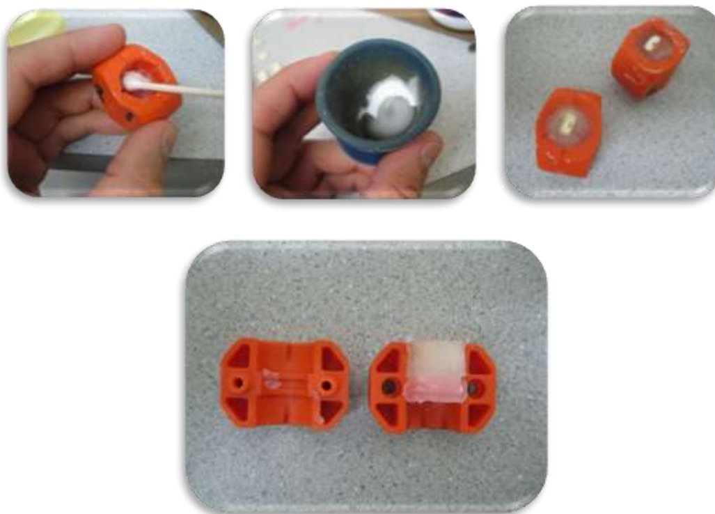
Fig. 5 Se colocó Vaselina dentro del molde, como separador. Se realiza la mezcla de acrílico fluido. Se colocan las muestras radiculares dentro del acrílico. Después de 20 minutos se desmontan los bloques de acrílico.
