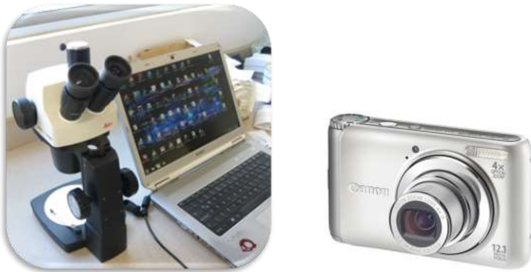
Fig. 6 Microscopio Leica Stereo Zoom 6 Photo, Camara Canon PowerShot A3100 IS utilizados para la toma de fotografías de las muestras.
