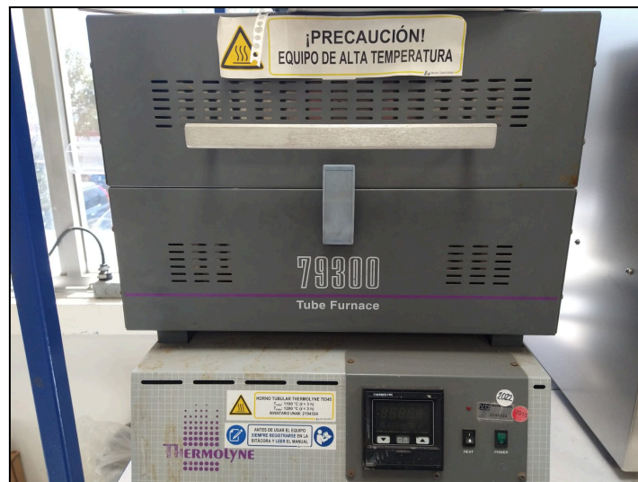
Figura 17. Horno tubular Thermolyne® modelo 79300.
