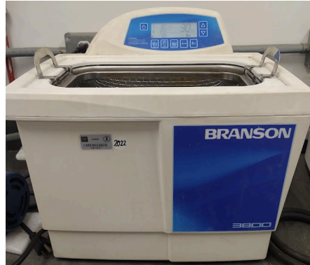
Figura 14. Fotografía del baño ultrasónico marca Branson®
