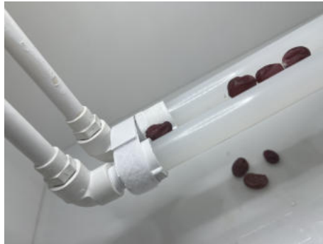
Figura 3.6: Tubería de PVC para la sujeción de los rodillos.
