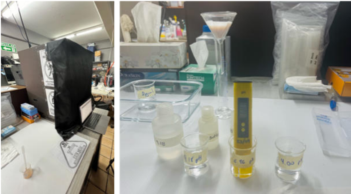
Figura 3.10: Montaje real del experimento químico para obtener el pH, grados Brix e índice de refracción del zumo de uva.
