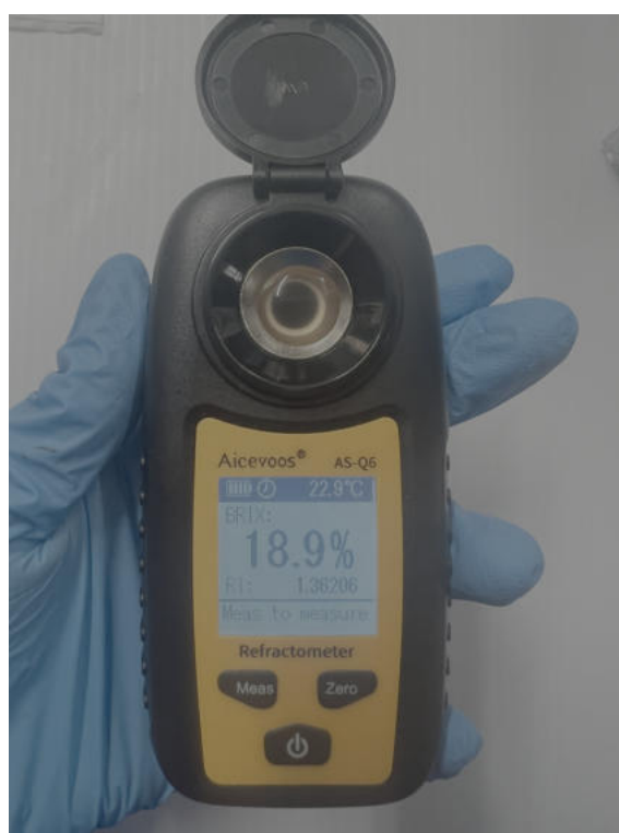
Figura 3.16: Medición de sólidos solubles totales (°Brix) en la muestra de zumo de uva del día, utilizando un refractómetro digital.
