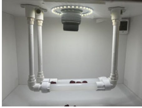
Figura 3.5: Rodillos de acrílico blanco para la colocación de las uvas.
