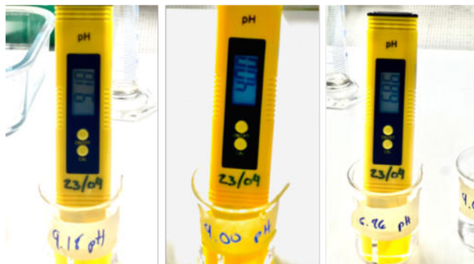
Figura 3.15: Calibración de pH-metro amarillo por medio de buffers preparados para 4.0, 6.86 y 9.18 de pH.
