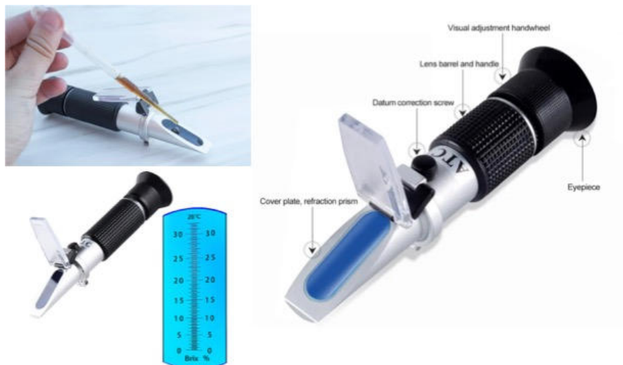
Figura 2.9: Refractómetro manual utilizado en este proyecto: partes y funcionamiento.
