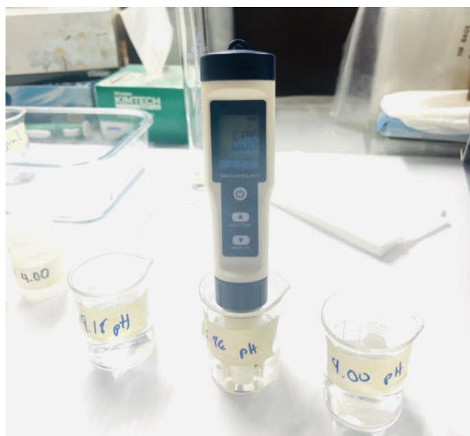
Figura 3.14: Calibración de pH-metro blanco por medio de buffers preparados.
