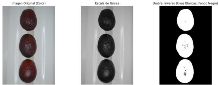
Figura 2.38: Umbralización binaria aplicada a una imagen de uvas de vino de este proyecto para identificar las región de interés.
