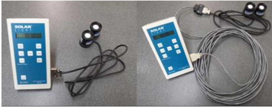
Figura 17. Arnés para utilización de cabeza detectora a una altura máxima de 12m
