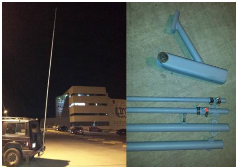
Figura 18. Mástil telescópico para mediciones a una altura máxima de 12m
