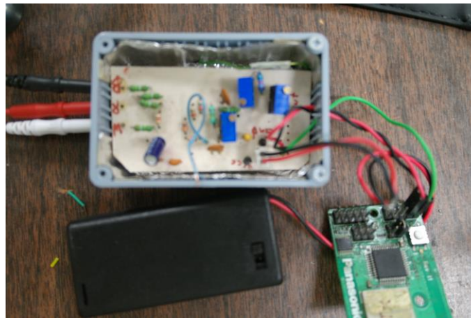
Figura 6.8 Interconexión del ECG con el nodo sensor
