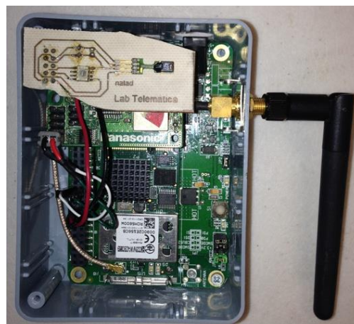
Figura 6.17 Integración del puente IEEE802.15.4/Wi-Fi
