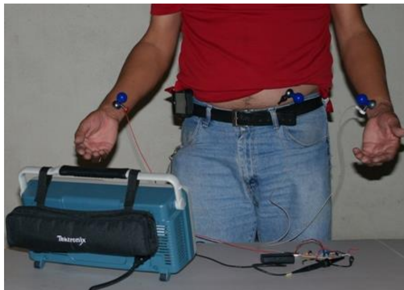
Figura 6.2 Colocación de los electrodos en el paciente
