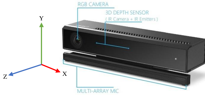
Figura 3.2: Sensor Kinect2. Sensor 3D se divide en dos cámaras infrarrojas: emisora y receptora. En un espacio de coordenadas cartesianas, el eje Z define la profundidad.
