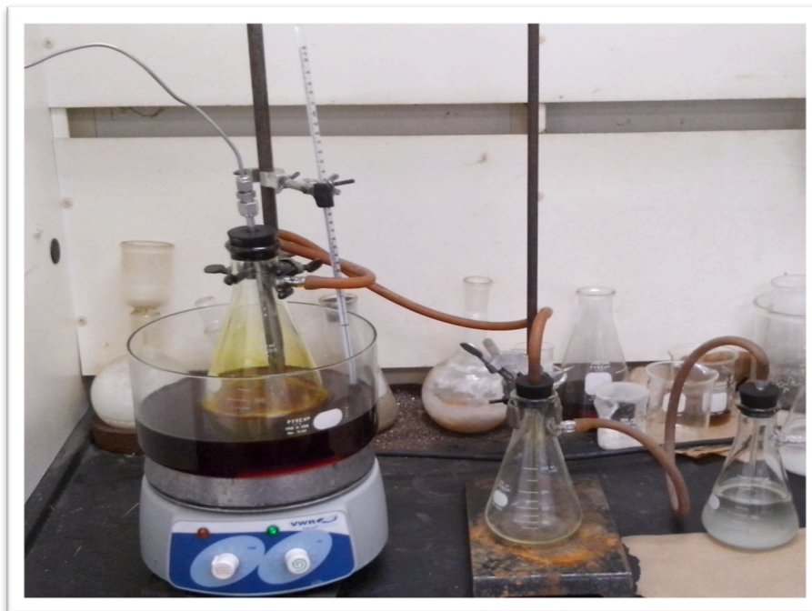
Fig. 3: Sistema utilizado en el método de síntesis convencional para el tiotungstato de amonio.
