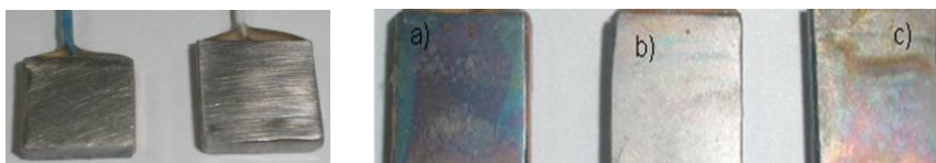
Figura 4. Izquierda: blancos Ti grado 2 y 5, derecha: a) anodizado sin NaOH, b) anodizado con NaOH y c) anodizado con NaOH y tratamiento térmico.
