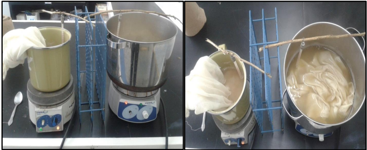
Figura 13: Substratos en agua con yeso al 3% a 80°C por cuatro horas.
