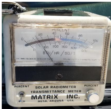
Figura 36 con el radiómetro solar en posición se tomaron lecturas cubriendo el sensor con las muestras.
