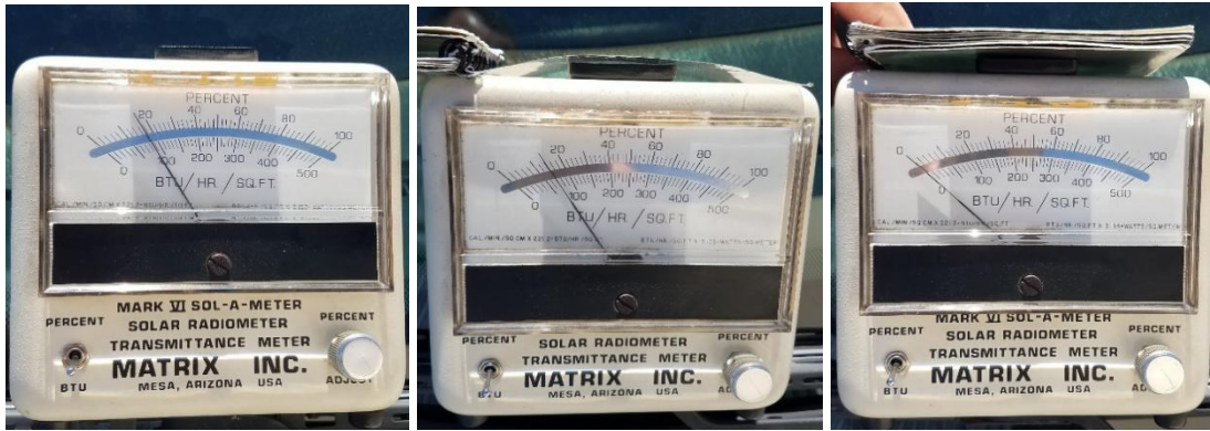
Figura 30 (a) se toma la lectura con el sensor descubierto directamente hacia el sol. (b) se toma la lectura con el sensor cubierto con la muestra. (c) se toma la lectura con el sensor totalmente tapado.
