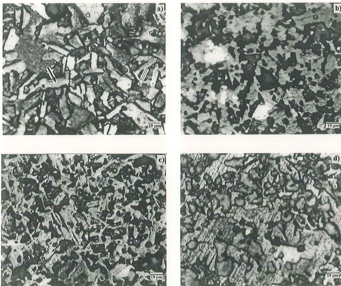
Figura 21. Microscopía óptica de muestras de Y_1Ba_2Cu_3O_{7-x} pulidas con pasta de diamante de 1\ \mu m : a) No irradiada, b) irradiada a 50 Mrad, c) irradiada a 100 Mrad y d) irradiada a 150 Mrad.
