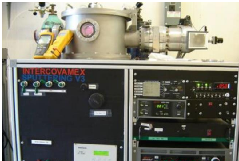
Figura 54. Equipo Sputtering que se usara para la deposición de las películas delgadas de SiAlON . [113]
