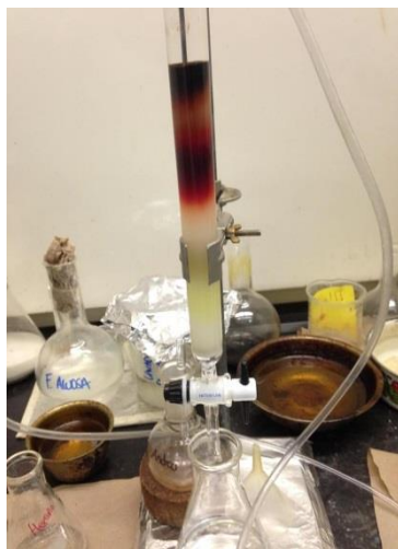
Figura 19. Cromatografía en columna del crudo de reacción de la apertura del epóxido con propilamina.
