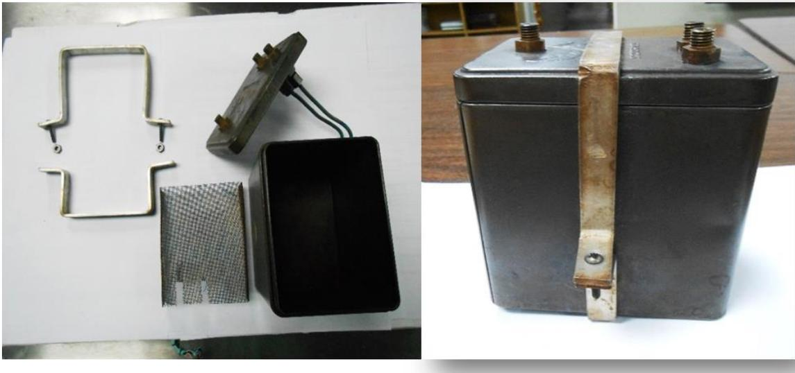
Figura 3.3. Reactor asegurado para entrar al horno
