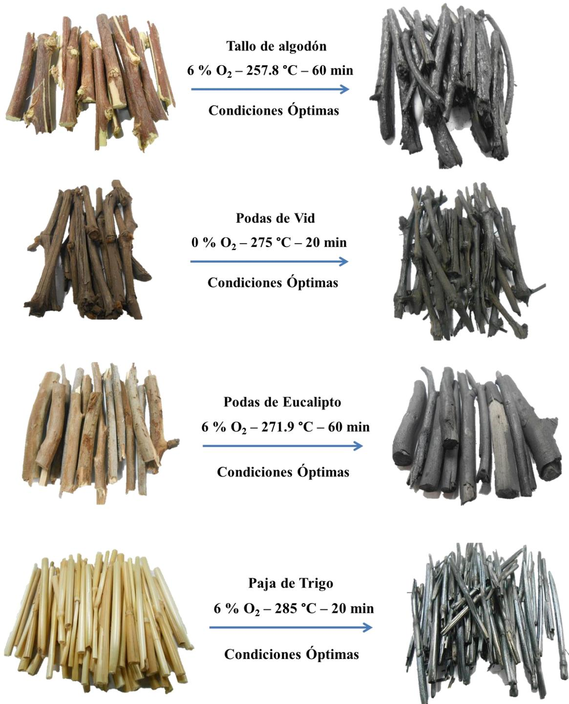
Figura 4.9. Condiciones óptimas de torrefacción para diferentes biomásas
