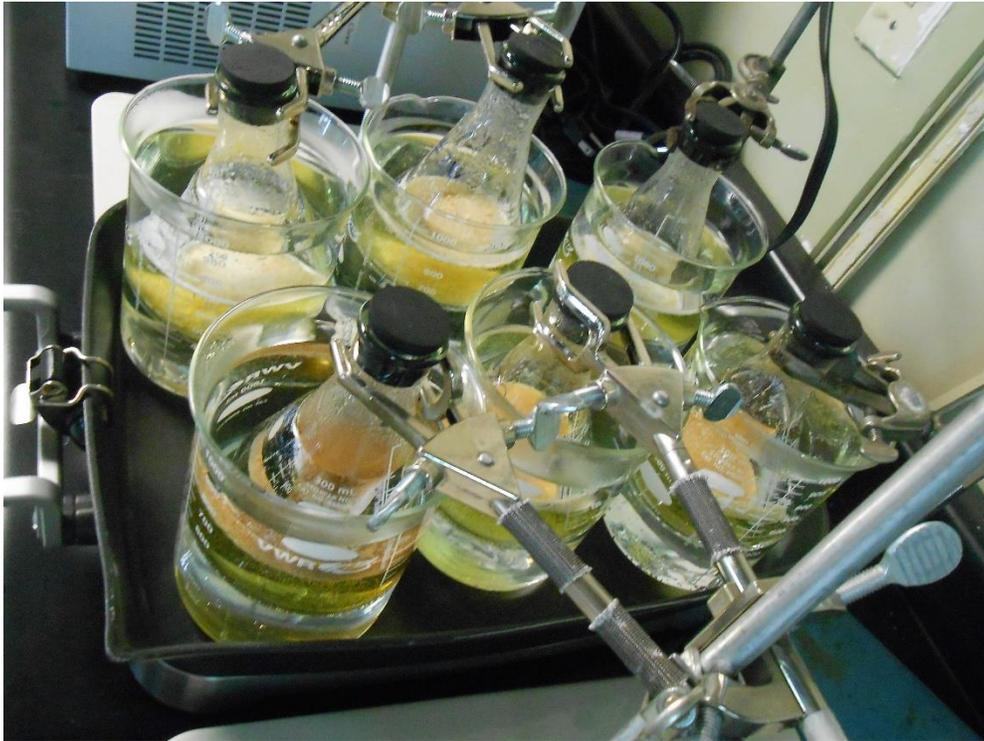
Figura 3.11. Montaje para la determinación del porcentaje de Holocelulosa
