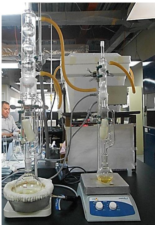
Figura 3.72. Equipo de extracción Soxhlet
