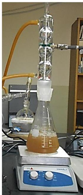
Figura 3.10. Determinación de lignina insoluble en ácido
