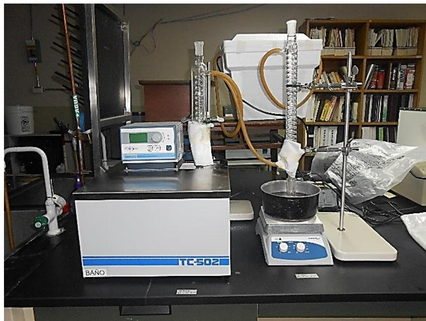
Figura 3.8. Extracción en agua caliente
