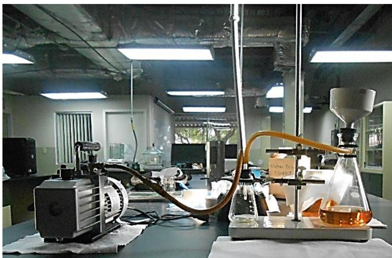
Figura 3.9. Filtración al vacío de los extractos cetónicos
