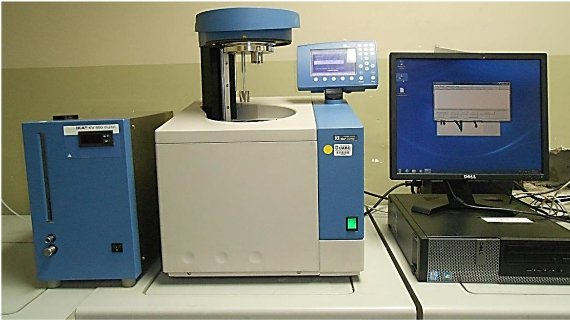
Figura 3.14. Bomba Calorimétrica IKA C2000
