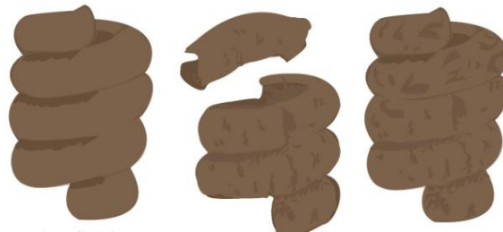
Figura 62 Posibles resultados al aplicar la evaluación de plasticidad por técnica de cordón “Cola de cochi”.
