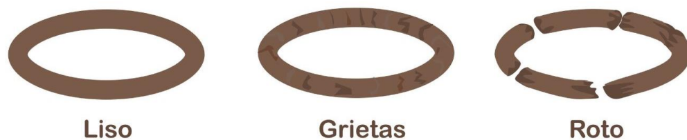
Figura 64 Posibles resultados de las pruebas de aro Elaborado por Cristina Ruiz Díaz
