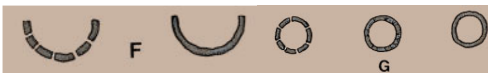
Figura 35 Procedimiento para determinar las clases texturales de suelos forma de aro.
