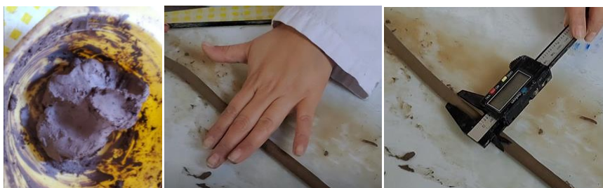
Figura 58 Imágenes del proceso para análisis textural de suelos arcillosos.
