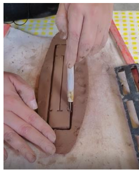
Figura 67 Elaboración de placas para evaluar la deformación de las arcillas después de una cocción.
