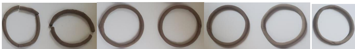
Figura 76 Resultados de análisis de plasticidad por aro, las muestras numeradas de izquierda a derecha 1, 2, 2.1, 3, 3.1, 4, 4.1 y 5.
