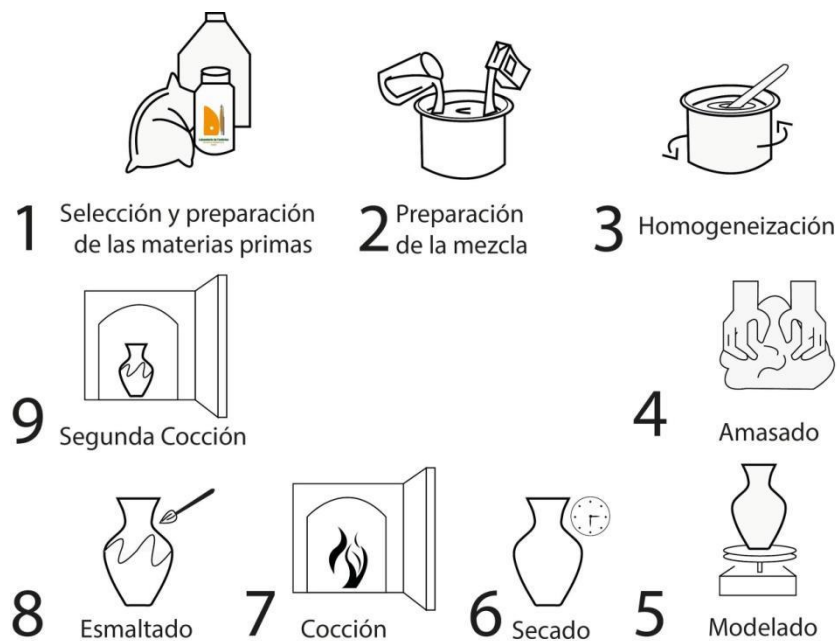
Figura 8 Proceso de elaboración básica de la cerámica. Fuente: elaboración propia.
