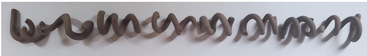
Figura 75 Resultados de análisis de plasticidad por cola de cochino, las muestras numeradas de izquierda a derecha 1, 2, 2.1, 3, 3.1, 4, 4.1 y 5.
