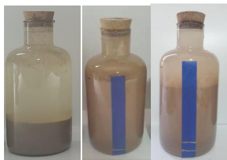
Figura 60 Imágenes de proceso de sedimentación. Gracia 2021.
