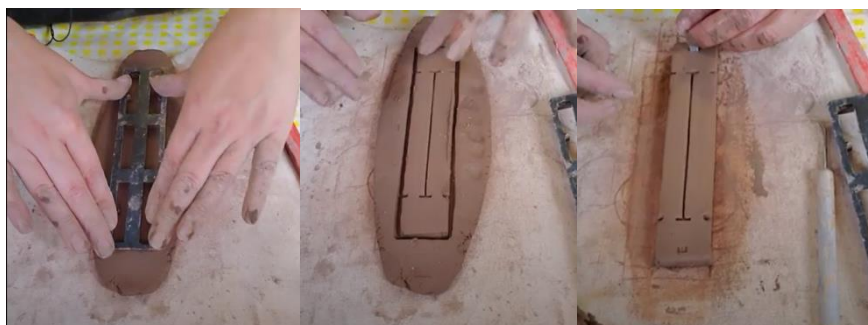
Figura 65 Procedimiento para la elaboración de placas de contracción.
