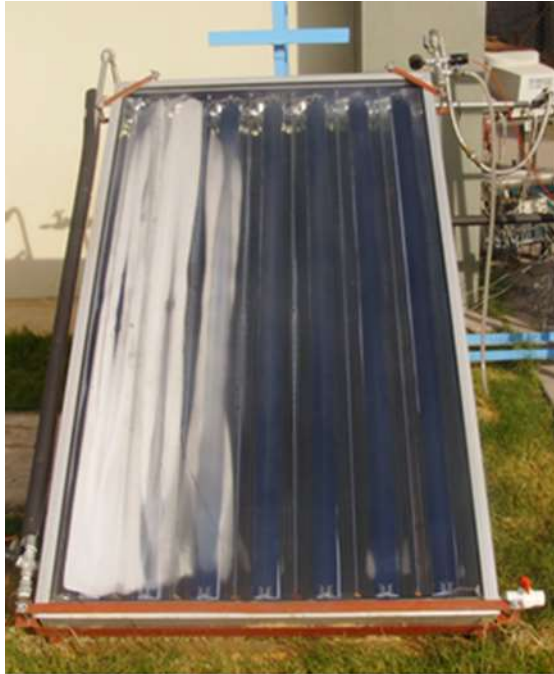
Figura 4.32 Fuga en el colector CPC.
