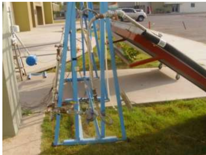
Figura 3.2 Base vertical y bases de colectores.
