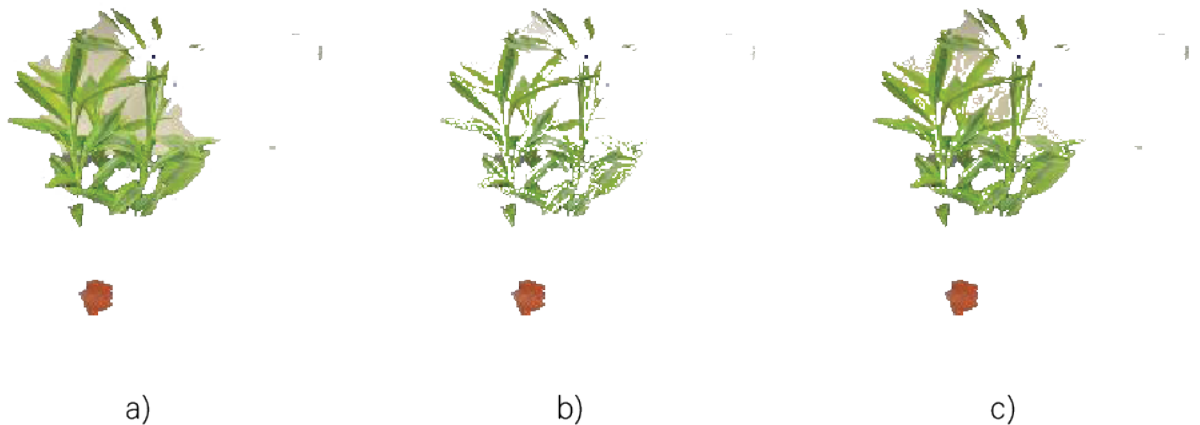
Figura 3.4: Post-procesamiento de imagen segmentada con dos distintos valores de umbral sobre el canal verde. a) Segmentación inicial b) Umbral de 180 c) Umbral de 200
