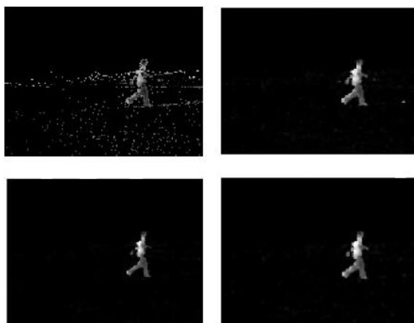
Figura A.4. Ejemplo de método de substracción de fondo para detección de objetos (Imagen tomada de L. Ssu-Wei Chen, "Moving Object tracking Based on Background Subtraction Combined Temporal Difference", [43]).
