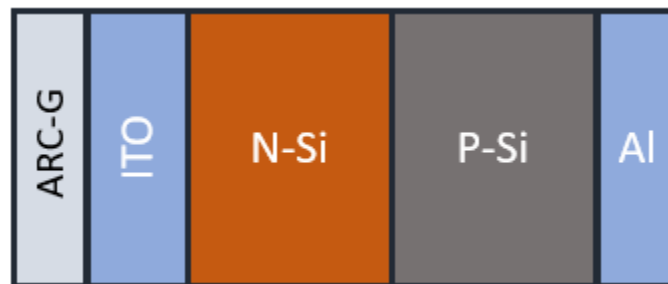
Figura 3.1: Estructura del sistema propuesto de celda unitaria sin pozo cuántico.
