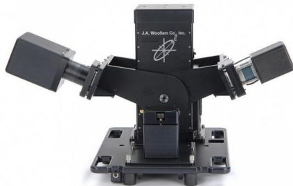
Figura 3.6: Elipsómetro utilizado para el Cálculo de índice de refracción complejos utilizado en Si
