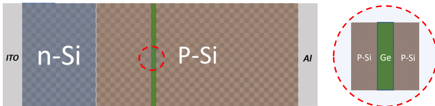
Figura 1.4: Celda de Si con pozo cuántico de Ge, la intención es promover la generación de enfriamiento óptico en la zona de depleción de la unión.
