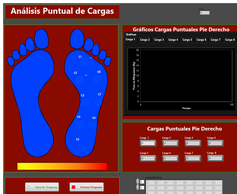
FIGURA 3.3: Panel frontal para el análisis puntual de cargas plantares.
