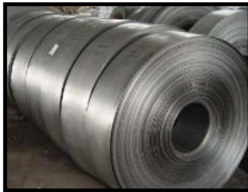
Figura 2. 10. Rollo de hoja de acero obtenido mediante proceso de laminación [7].
