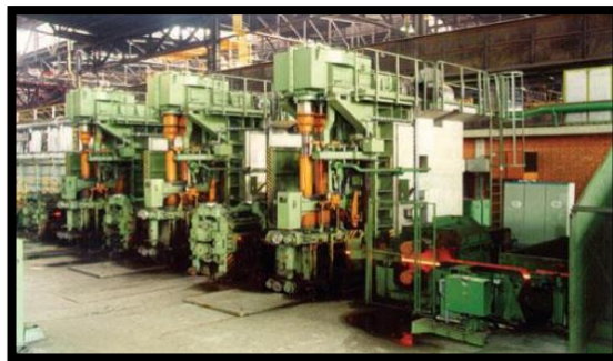
Figura 2. 12. Tren de laminación [7].
