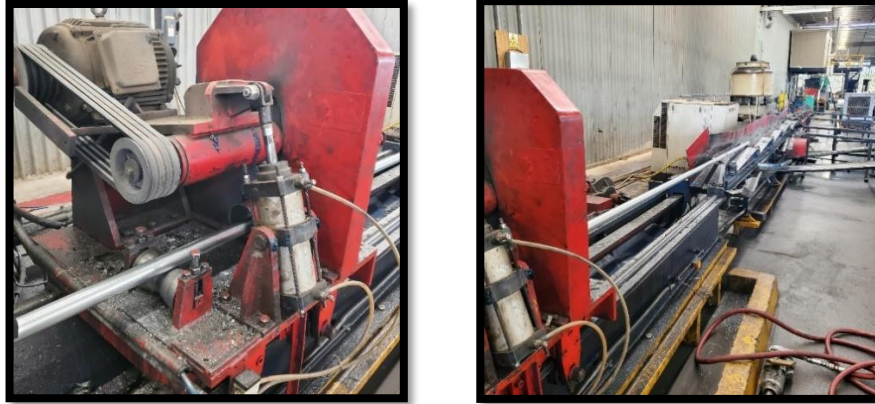
Figura 5. 9. Corte del material al finalizar el proceso (izquierda). Banda transportadora del material hacia el área de empacado (derecha).
