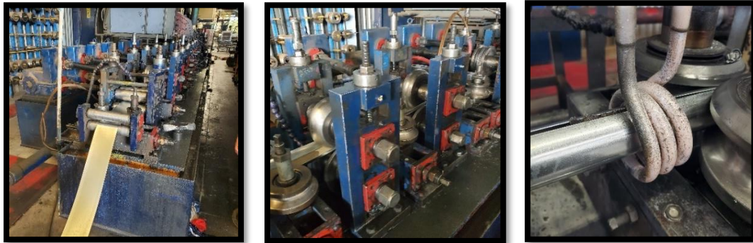
Figura 4. 10. Maquinaria para la fabricación de tubo redondo industrial con lámina de acero.
