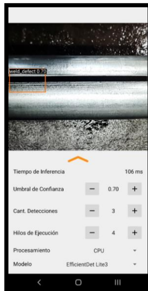
Figura 4. 18. Aplicación de detección de defectos en Android.
