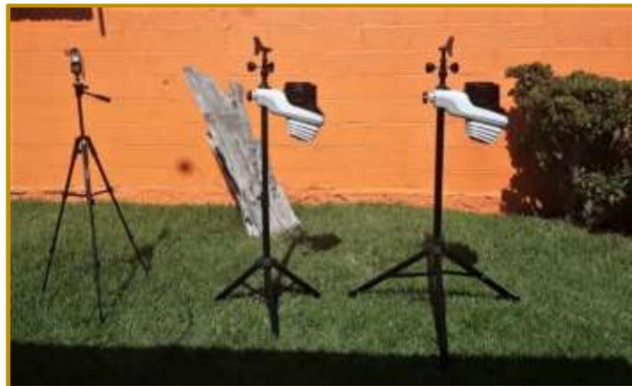
*Nota. Fotografía tomada en mayo de 2021, durante la calibración de instrumentos, Derecha Kestrel 50050L, centro EM-A Izquierda EM-B.*
