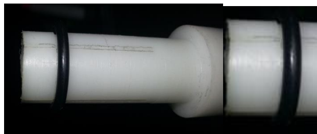
Figure 67. El ranurado para el oring se cambio de posición.
