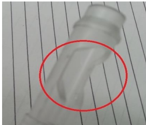
Figure 65. Barril Quebrado de la sección central.
