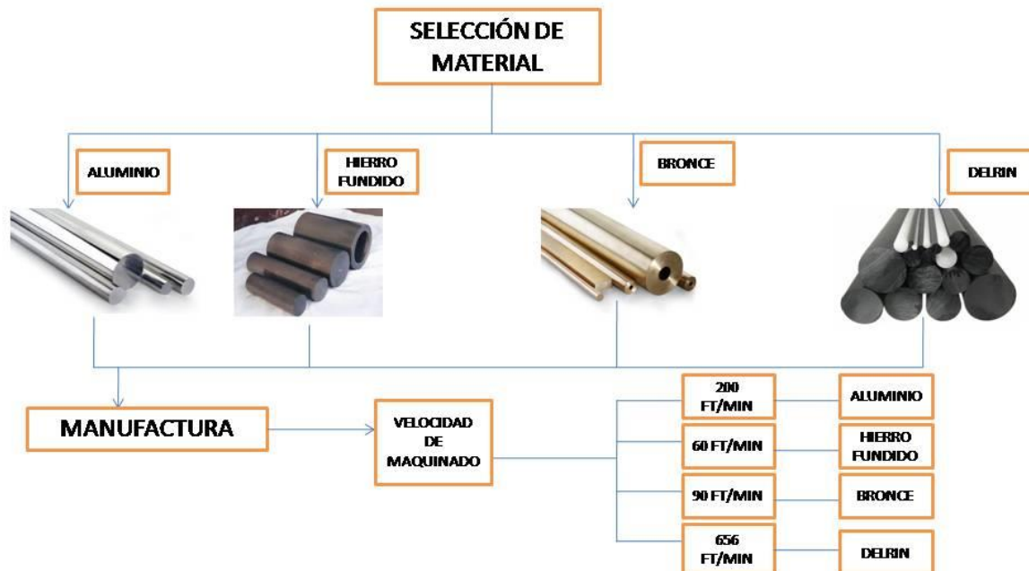
Figure 41. Diagrama que muestra la selección de material de acuerdo a su maquinabilidad.
