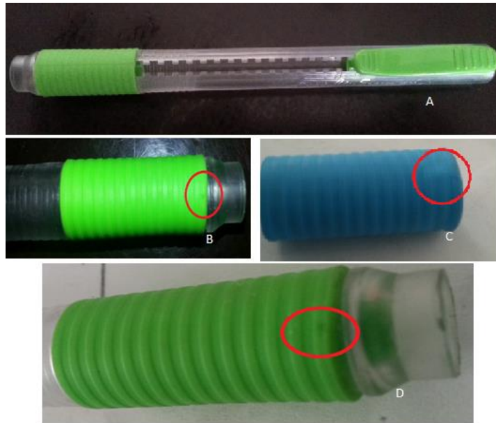
Figure 64. En la sección "A" observamos el producto final sin fallas; En la sección "B" encontramos el grip sumido y la punta del barril con un ligero rayón; En la sección "C" observamos el grip rayado; En la sección "D" encontramos el grip sumido.
