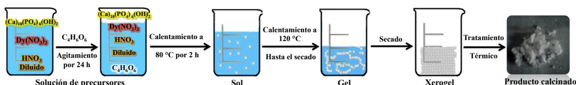
Figura 32. Síntesis de HAp:Dy<sup>3+</sup> por el método sol-gel.
