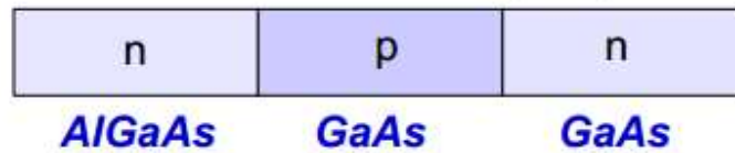
Ilustración 16: Ejemplo de una hetero-estructura, un transistor bipolar BJT.
