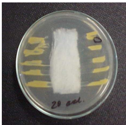
Figura 5.23 Resultado de la prueba de efectividad antibacterial de la muestra con microcápsulas de triclosan, después de 10 ciclos de lavado.
