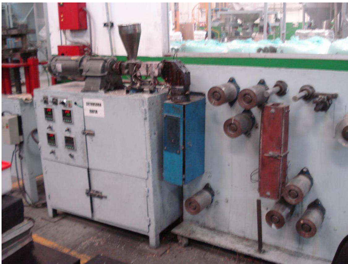
Figura 5.24 Equipo de extrusión para la obtención del filamento de polipropileno con y sin aditivos antibacteriales.
