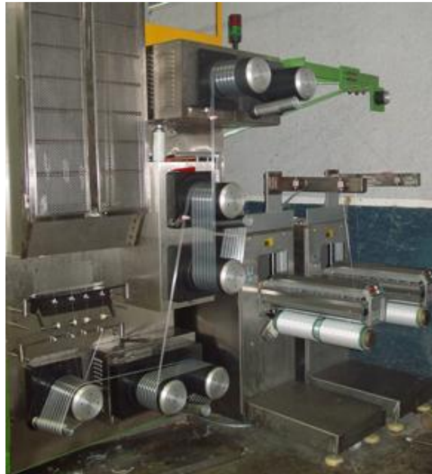
Figura 1.9 Maquina Extrusora de filamento de Polipropileno. (Con Autorización de Italian Textil® )
