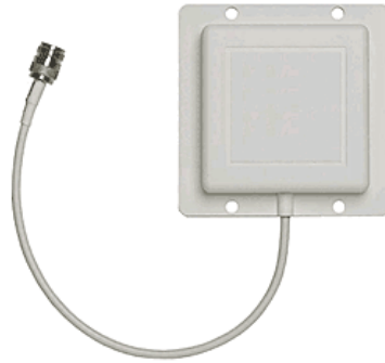
Figura 4. Las antenas Direccionales. Estas antenas "envían" la información a una cierta zona de cobertura.
