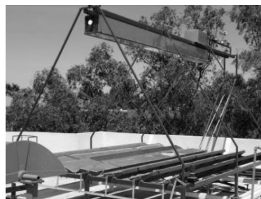
Fig. 15: Prototipo del CLF construido en la plataforma solar del Centro de Estudio de las Energías Renovables del Instituto de Ingeniería
