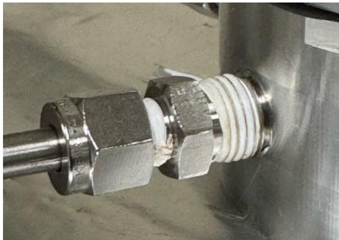
Figura 3.6. Entrada de precursor a la cámara.
