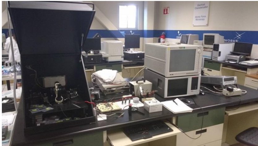
Figura 22 Sistema de caracterización de semiconductores Keithley 4200
