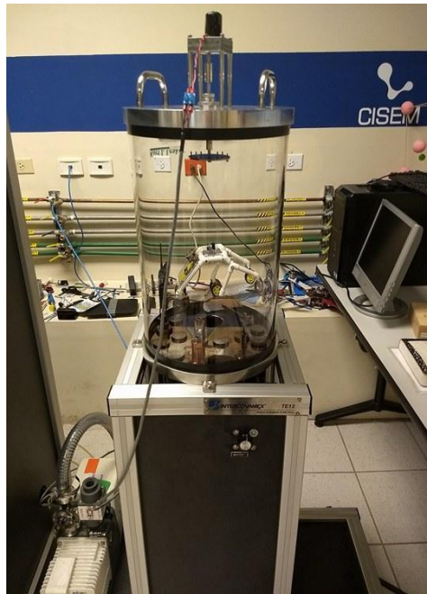
Figura 3 Sistema de depósito de alto vacío
