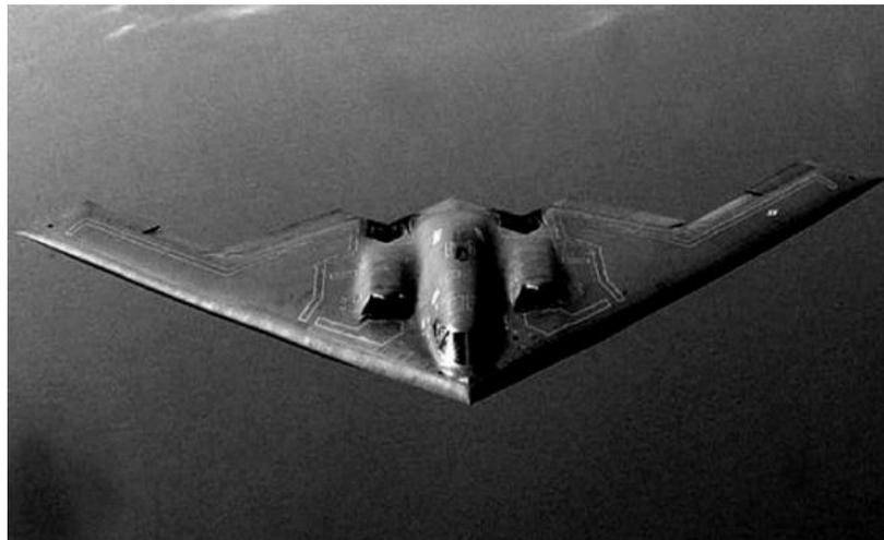
**Figura 34.** Bombardero B-2. Incluso una aeronave de sigilo de grandes proporciones tiene una sección transversal de reflectividad de radar no mayor a la de un ave. (Zachariah, 2009)
