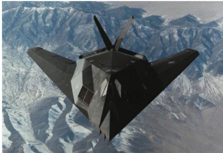
**Figura 35.** Dado que en esa época ningún radar tenía tanto una antena de baja RCS como con una baja probabilidad de que sus señales fueran interceptadas útilmente por un enemigo, el primer caza furtivo de Estados Unidos, el F-117 (Nighthawk), no estaba equipado con un radar. (Lockheed, 2019)
