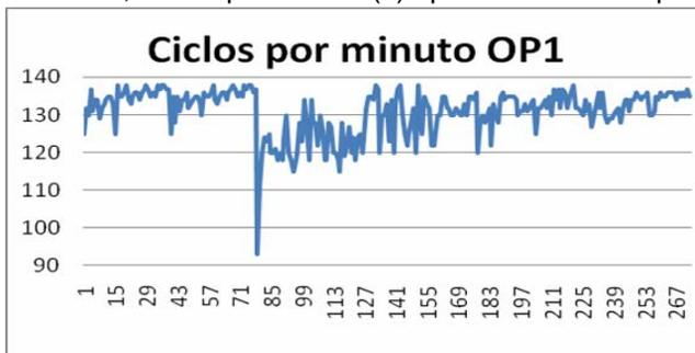
En la gráfica 3, se muestra el comportamiento de los ciclos por minuto a través del tiempo teniendo un mínimo de 93 movimientos y un máximo de 138 movimientos, con una media de 130.97 movimientos. Para mayor información ver la tabla 6.
