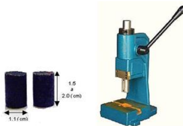
Figura 3.2 Prensa de tornillo manual para fabricar “pellets”.
