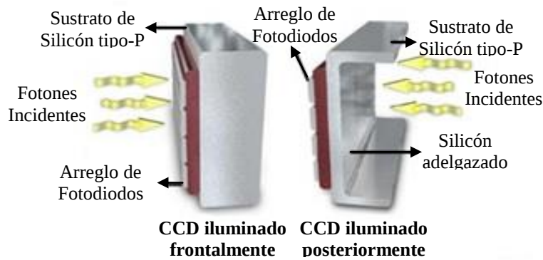
Figura 2.39. Diseño de un CCD iluminado frontalmente y posteriormente.
